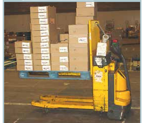
Transpalette à conducteur accompagnant avec fourche élévable (utilisé sur de faible distance de déplacement)
