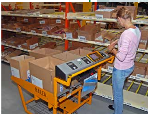
Chariot avec afficheur de commande, système de pesée et scanner intégrés
