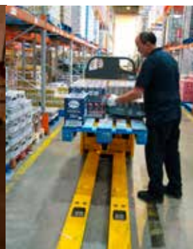
Transpalette gerbeur permettant également la dépose et le retrait des palettes en hauteur
