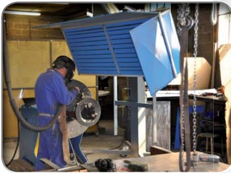
L'activité de soudage est importante pour cette entreprise de chaudronnerie car elle permet l'assemblage d'éléments qui ont été mis en œuvre à l'aide de cisailles, plieuses, rouleuses.
