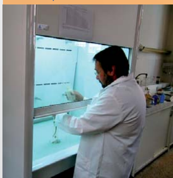
Vitesse d'air moyenne de 0,56 m/s (préconisée 0,4 m/s)
