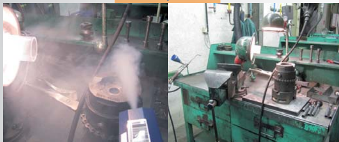
Ventilation peu efficace
