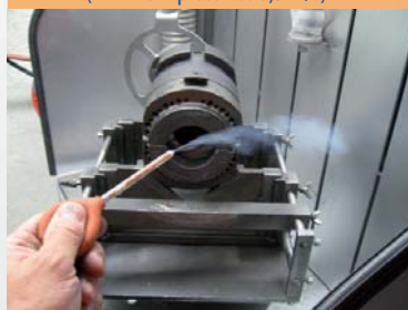
Vitesse d'air moyenne de 0,56 m/s (minimum préconisé 0,5 m/s)
